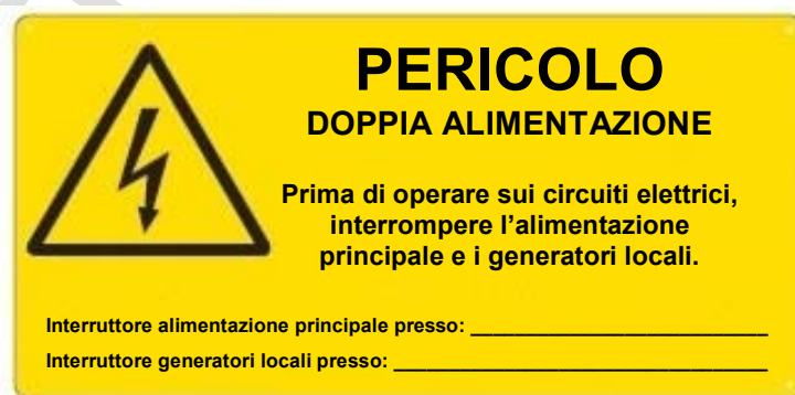
Figura 6.1 - Cartello di sicurezza per un impianto fotovoltaico collegato alla rete del distributore
